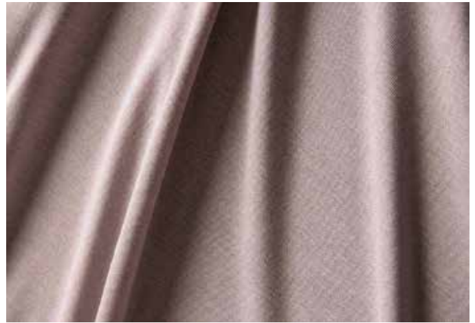
Bühler entwickelte viele neue Garne. Dieser Stoff aus Modalgarn hat hohe Trag- und Qualitätseigenschaften, wie sehr angenehm weich, atmungsaktiv, hautsympathisch, strapazierfähig und formbeständig. Modal ist eine nach einem chemischen Verfahren aus Buchenholz-Zellulose hergestellte Faser.
