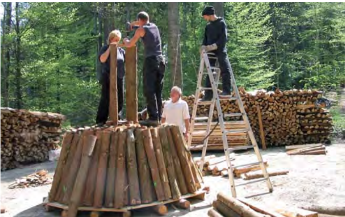
Die zweite Lage wird aufgeschichtet
