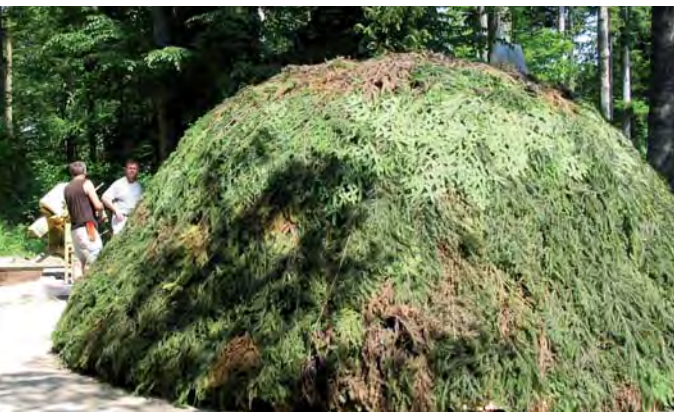
Abdeckung mit Mantel aus Tannenreisig; Grundlage für den Löschimantel
