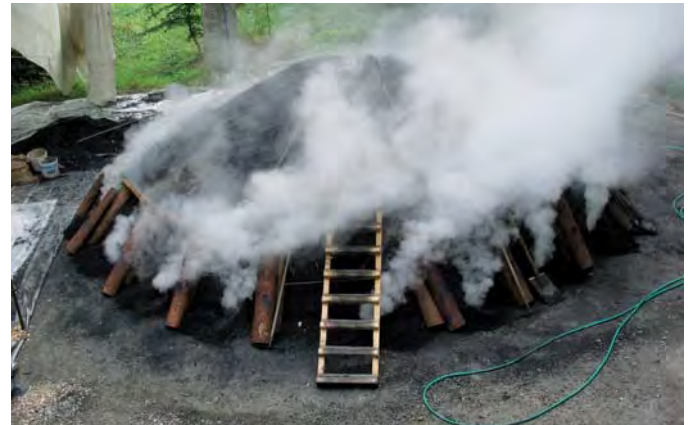
Meiler im Verkohlungsprozess; Die Farbe des Rauches zeigt den Zustand an
