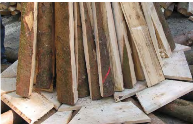
Die unterste Lage des Füllhauses mit Zusatzscheiten ist erstellt
