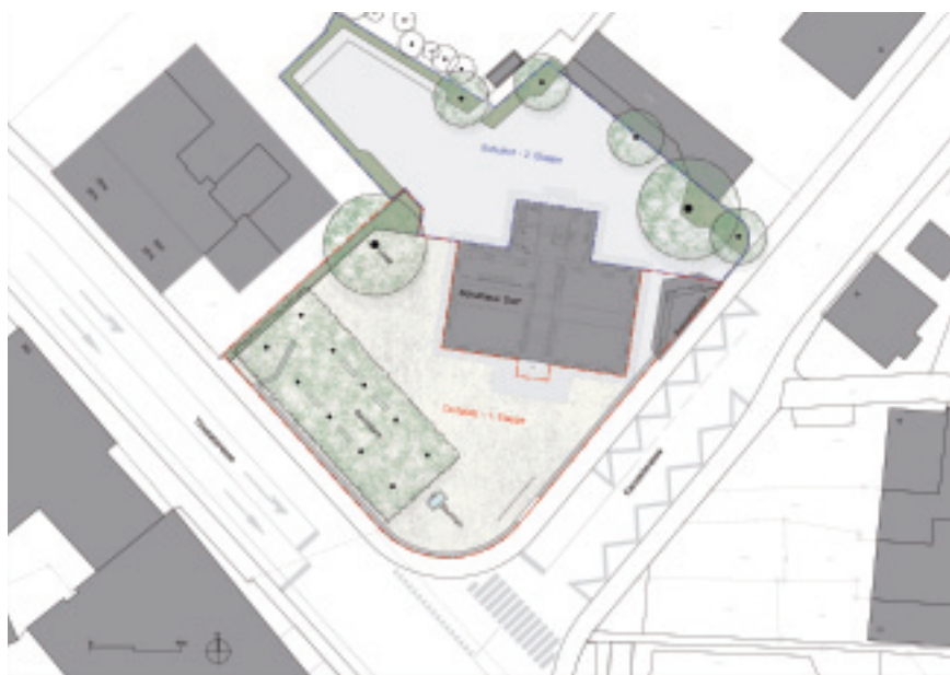
Situationsplan der Umbauten beim Schulhaus Dorf
