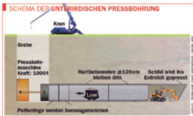
Schematische Darstellung des Pressbohrvortriebs
