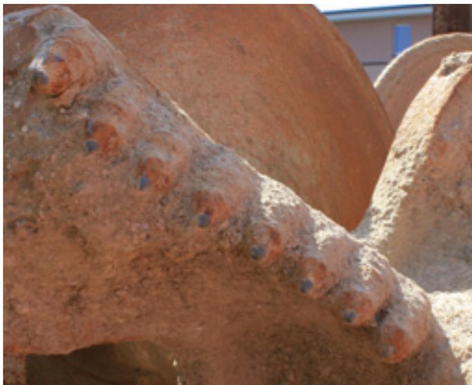
Detailansicht des Pressbohrkopfes
