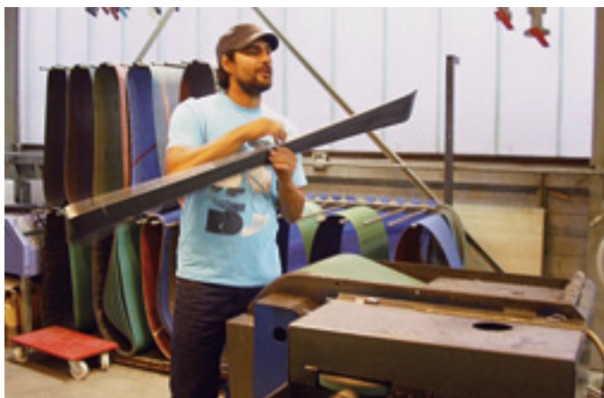
Marc Iselin demonstriert die Herstellung eines Skis in seinem Einmannbetrieb.
