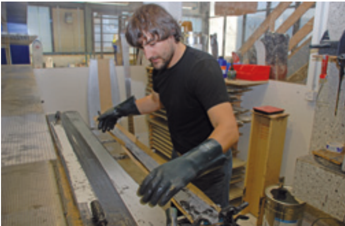
Eine Schicht Leim hält verschiedene Materialschichten zusammen
