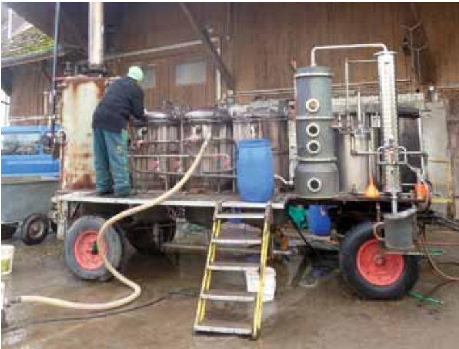
Diese fahrbare Schnapsbrennerei besteht aus: vlnr dem Dampfkessel zum Erzeugen des Heizdampfes, den drei Brennkesseln, dem Kondensator (mit den vier Schaugläsern), dem Kühler (hoher, schmaler Zylinder) und dem Auslauf mit dem Auffangkessel.
