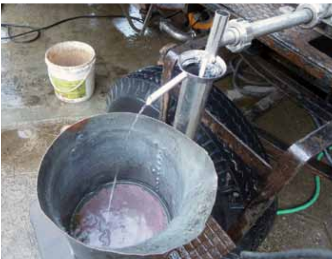
Anhand der speziellen Form und der Intensität des Schnapsstrahles sowie dem schwimmenden Alkoholmeter spürt der Brenner die Qualität des gebrannten Schnapses.
