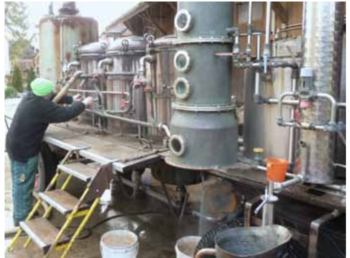
Im Kondensator links wird zuerst der mitgeschleppte Wasserdampf kondensiert und ausgeschieden, dann der Alkoholdampf verflüssigt (unter 68 °C) und im rechten Kühler auf Normaltemperatur abgekühlt und im Auffangkessel gesammelt.
