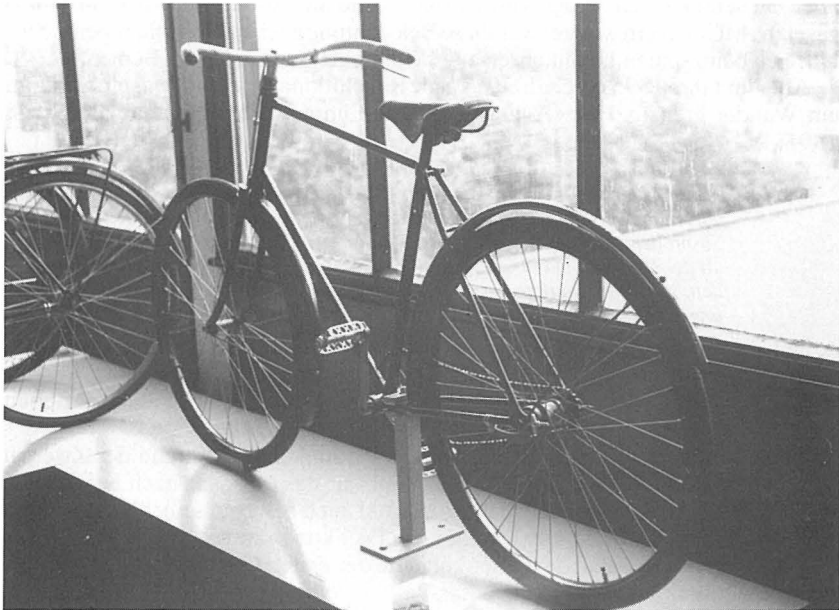
Ein Fahrrad, Marke Dunlop, aus dem Jahre 1895. Beachtenswert ist die Luftbereifung mit Ventilen, wie sie noch heute verwendet werden. Die Rücktritt-Bremse, Marke Torpedo, wurde jedoch erst nach 1900 eingebaut.
