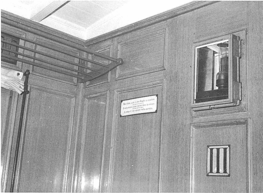
Eine Petrollampe, eingebaut in die Stirnseite des Wagenabteils, spendete spärliches Licht, so dass der Konkukteur die Fahrgäste mit der Handlaterne suchen musste.
