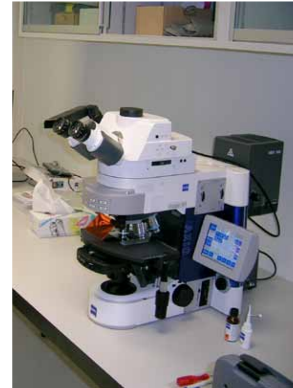
Forschungsmikroskop mit Fluoreszenzeinrichtung zur Zählung von Gewässerbakterien.
