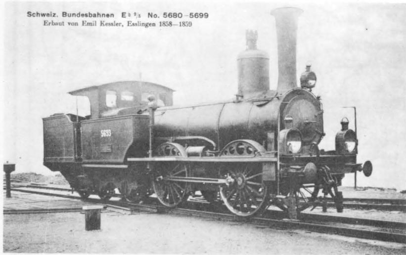
Engerth-Lokomotive B3' (Eb 2/5) der Vereinigten Schweizerbahnen, wie sie für die Schnellzüge Zürich-Chur auf der Glattalbahn verwendet wurden. Für die VSB charakteristisch ist dabei der auf einem unter dem Führerstand weiterlaufenden Drehgestell abgestützte Schlepptender. Einige dieser von 1858 bis 1860 stammenden Lokomotiven gingen noch auf die SBB über, so die hier dargestellte Nummer 5693 (Bild: Archiv Dr. Schwabe, Basel.)
