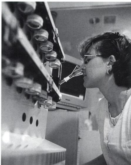
*Der «Virtual Aroma Synthesizer» mischt die Inhaltsstoffe eines Aromas so, dass es Sekunden nach der Kreation beurteilt werden kann.*
