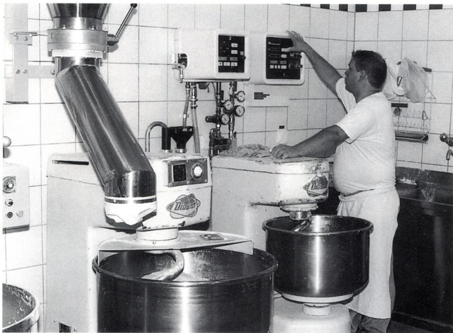
*Teigherstellung: Per Knopfdruck gelangt die richtige Mehlmischung über eine Rohrleitung aus dem Mehlsilo direkt in die Misch- und Knetmaschine, wo Wasser, Hefe und Salz beigefügt werden.*
