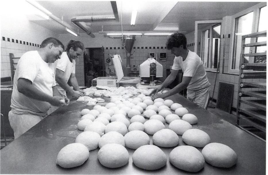
*Nach dem Kneten erhalten die Teiglinge mit gekonnten Handgriffen die Brotform. In der Gärstoppanlage ruhen sie anschliessend bei Null Grad, bis die Hefe langsam durch zunehmende Wärme und Feuchtigkeit rund fünf Stunden vor der Backzeit erwacht und den notwendigen Gärungs- und Reifeprozess auslöst.*
