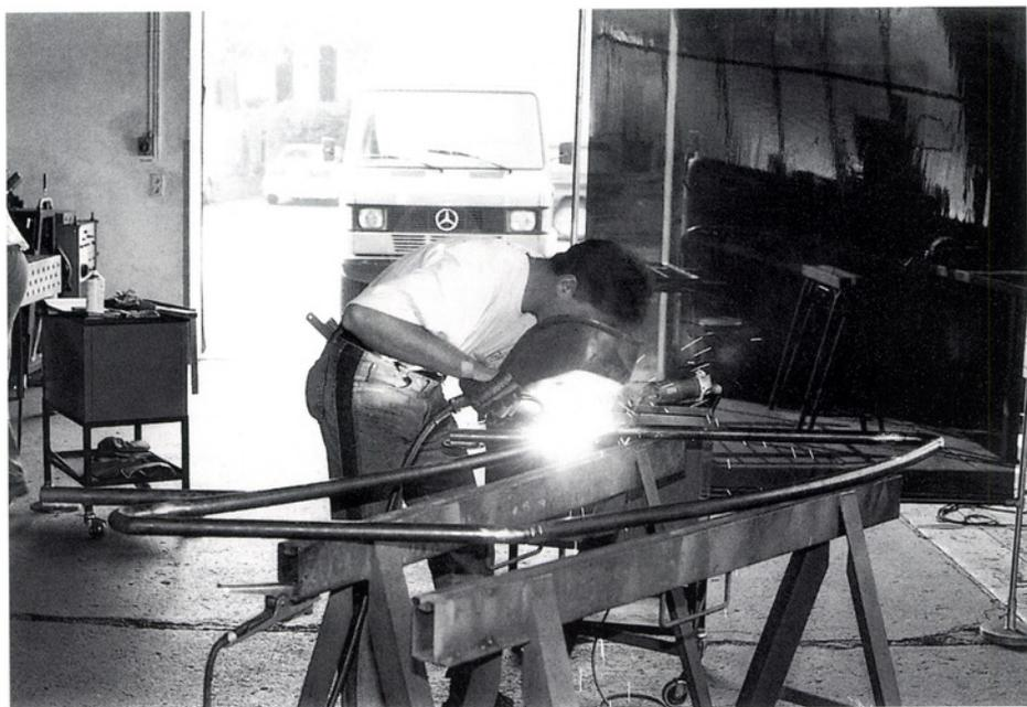
*Das Schutzgas-Schweißen löste vor einigen Jahren das Schweißen mit Elektroden ab und zählt heute im Metallbau zu den wichtigen Verbindungstechniken.*
