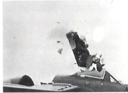
*Ablauf eines Dachdurchschusses des Piloten aus dem Cockpit eines Venom.*
