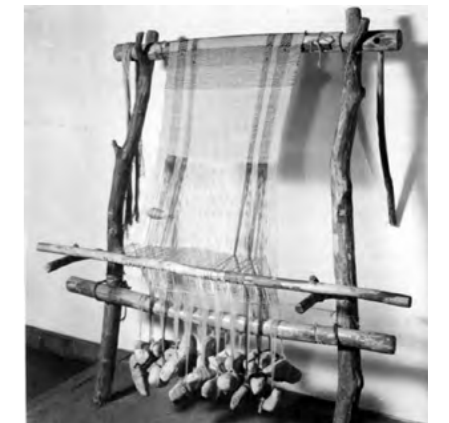
Steinzeitlicher Webstuhl. Die Steine (Wirtel) zum Strecken der Kettfäden sind häufige Ausgrabungsfunde.
