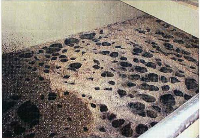
Die Mikroorganismen im Sand fällen die gelösten Stoffe aus dem Abwasser aus, die anschliessend zusammenklumpen.
