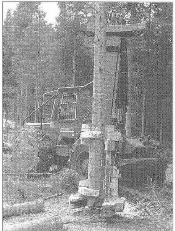
*Der Vollernter entastet und schrotet den Stamm, sägt ihn vom Wurzelstock und lädt ihn auch gleich auf den Langholzwagen; nötigenfalls schneidet er ihn zuvor noch auf vorgeschriebene Länge. Holzfällen im Einmannbetrieb ...*
