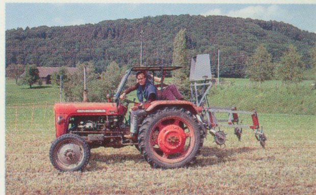
Abb. 3 Geoelektrische Messungen in Unterstammheim Photo P. Nagy
