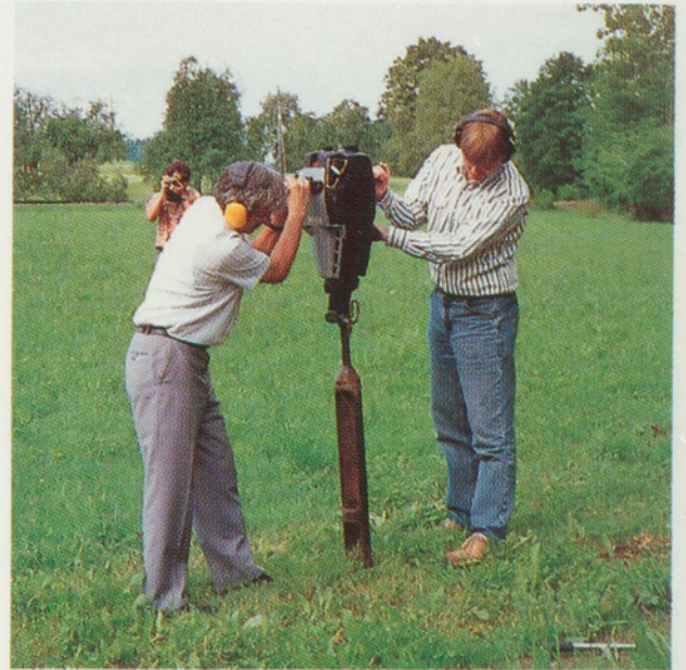
Abb. 22 Bohrprospektion mit einem motorbetriebenen Bohrer
