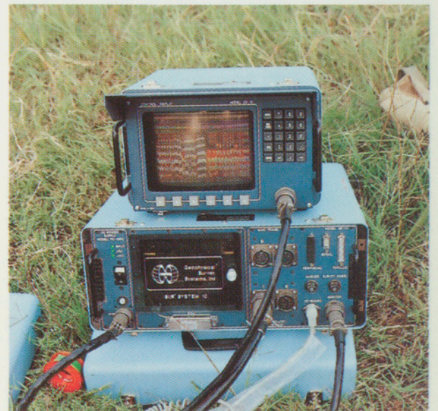
Abb. 19 Die Abbildung des Messgerätes mit dem dazugehörigen Bildschirm des Radars zeigt, wie klein die heutigen Apparaturen sind (die Geräte für Widerstands- und Magnetfeldmessungen sind etwa gleich gross).
