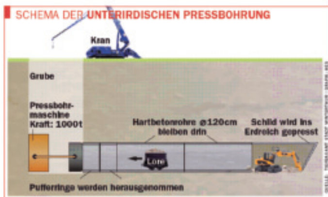
Schematische Darstellung des Pressbohrvortriebs
