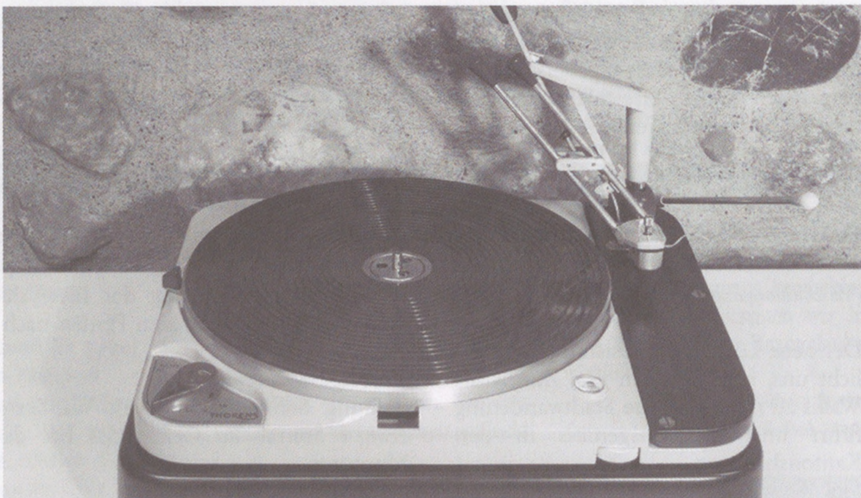
Da schlägt das Herz des Vinyl-Liebhabers heftig höher: Thorens-Plattenspieler TD 124 mit Tangential-Stereo-Tonarm-Prototyp von Hi-Fi Schopper aus Winterthur.
