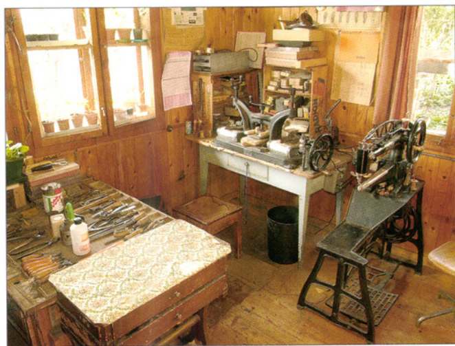
Schuhmacher-Werkstatt von Robert Gujer am Originalort. Blick auf den Arbeitsplatz. Am linken Bildrand befindet sich die Werkbank; rechts davon in der Mitte der Lederbocker. Auf der rechten Seite steht auf dem Tisch der Sohlenspanner zum Leimen der Sohlen; im Vordergrund rechts steht eine rund 100 Jahre alte Nähmaschine.
