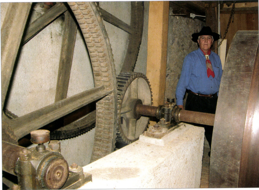
Die durch den Gewerbeverein Maur wieder in Stand gestellte Säge mit ihrem unterirdischen Antrieb und – im Hintergrund – Jakob Frei, dem «guten Geist» der Säge. (Foto: Gisela Goehrke)
