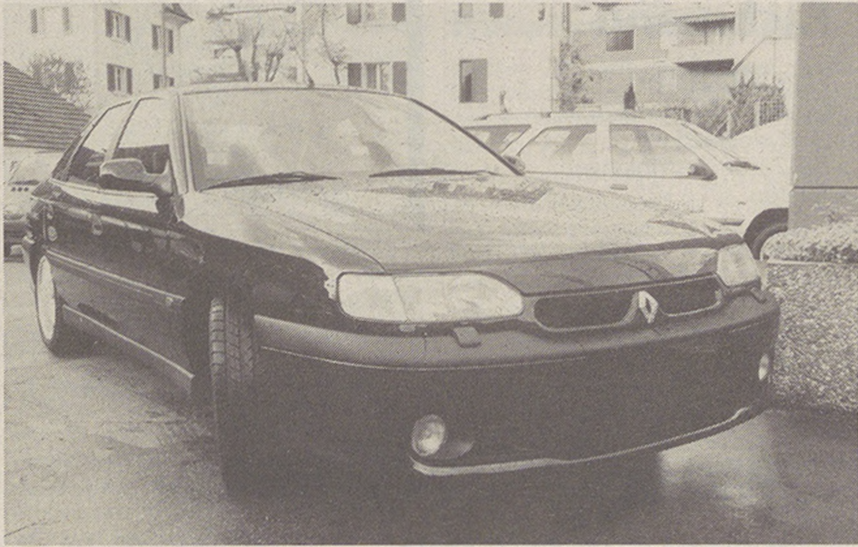
Safrane Biturbo, 3-Liter-V6-Motor mit 268 PS. Superausstattung für eine sportliche Luxuslimousine fällt der elastische Motor auch im unteren Drehbereich angenehm auf. Allradantrieb zur einwandfreien Übertragung der grossen Motorenleistung auf die Fahrbahn.
