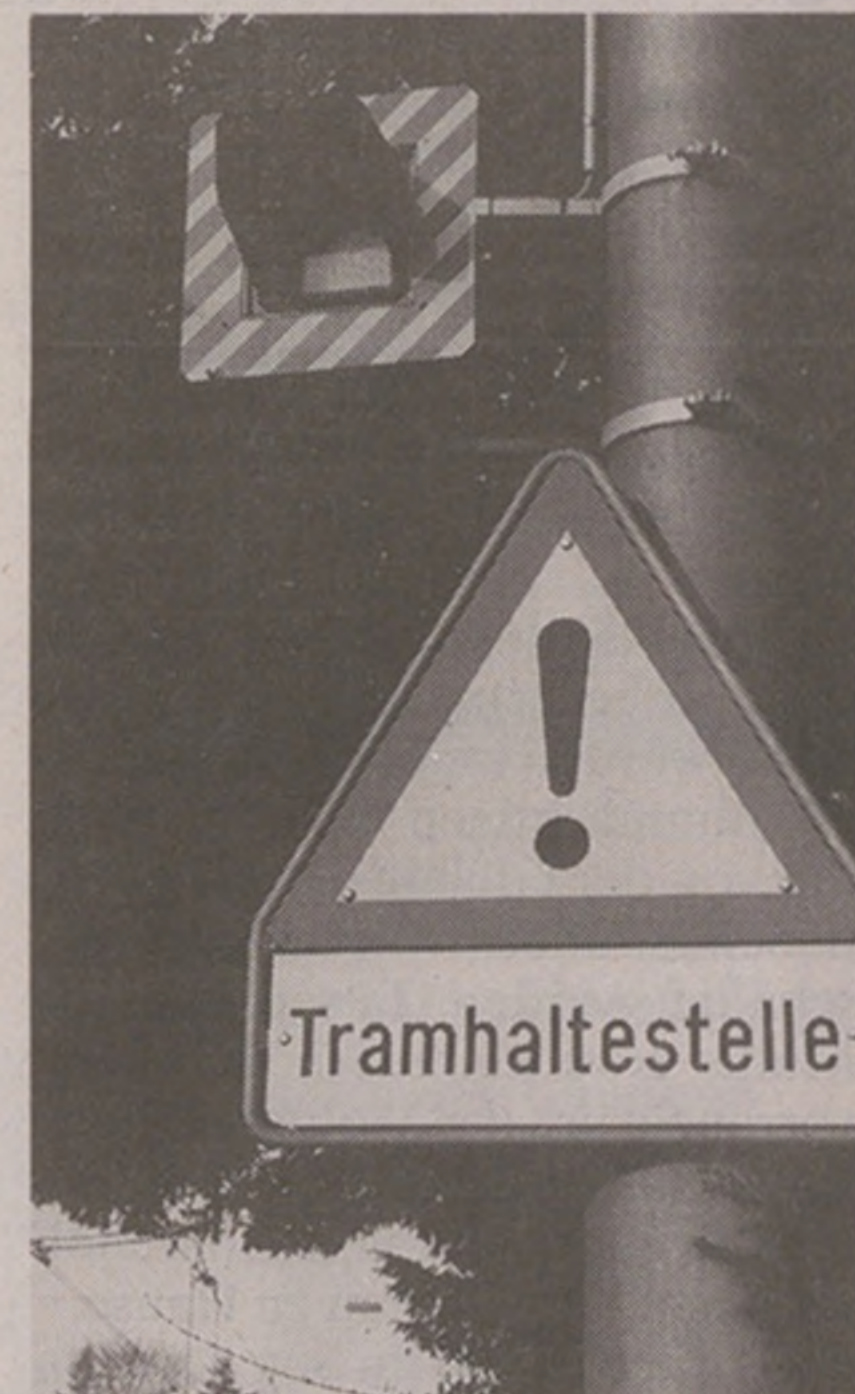
Das Signal mahnt die Verkehrsteilnehmer zur Vorsicht. Die elektronische Anzeige darüber orientiert die Tramführer über den Stand der Weichen.
