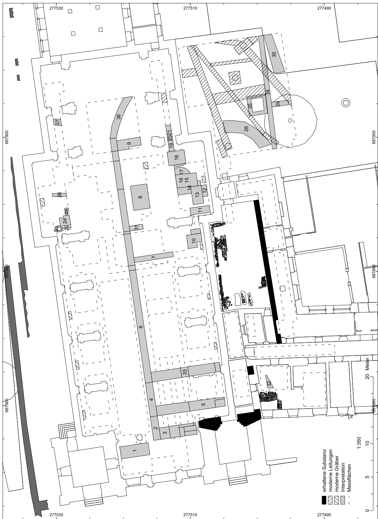
Abb. 24 Rheinau. Ehem. Kloster. Interpretation der Bodenradardaten. Zusätzlich sind die noch erhaltenen und die bereits ergrabenen Strukturen eingezeichnet. Mst. 1:350.
