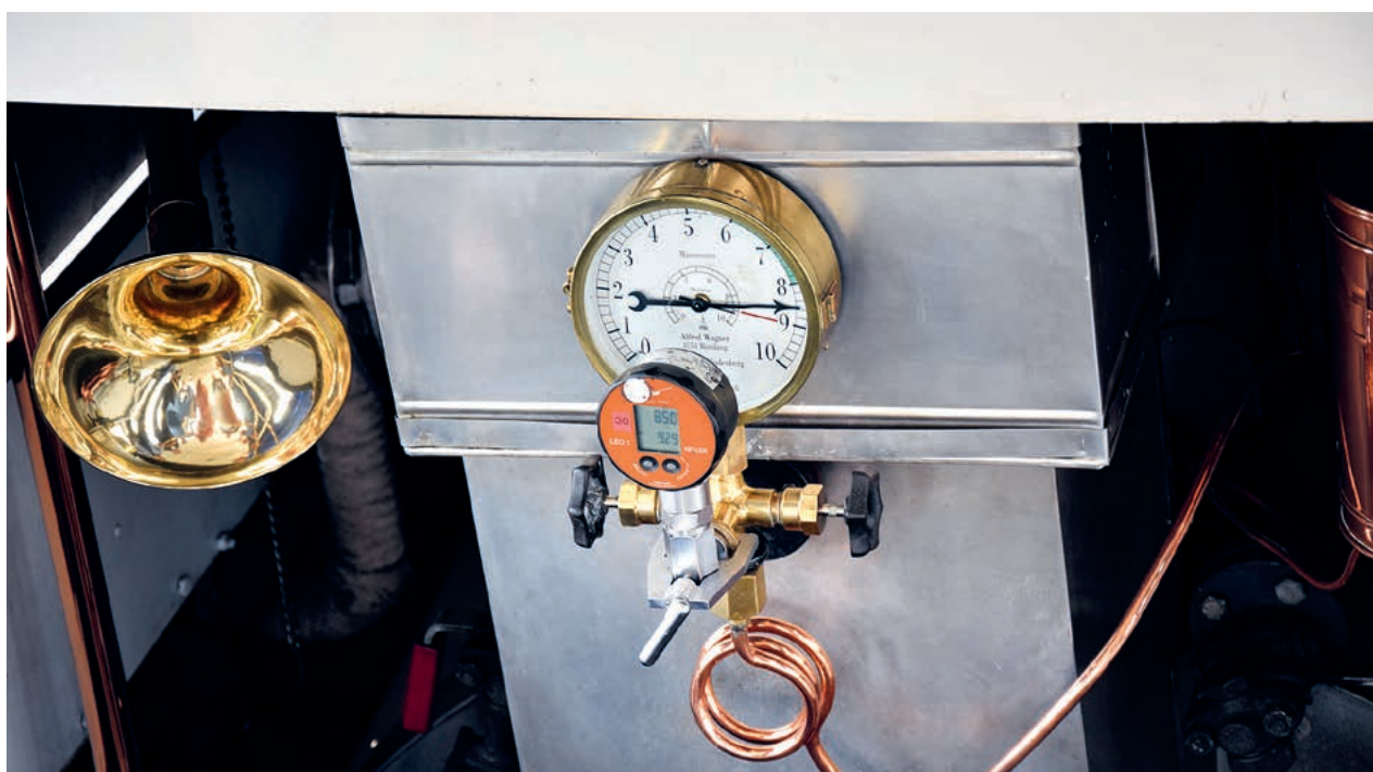
Der Druck steigt und steigt. Bis zum roten Strich gehts noch, dann muss sich das Sicherheitsventil des Kessels öffnen – sonst fliegt der Kessel in die Luft! Bild: Dörte Welti
