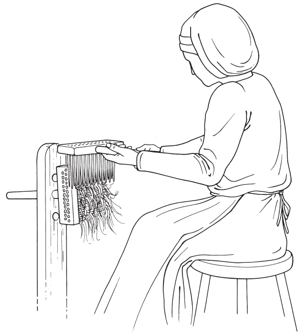
Abb. 89. Bearbeitung von Wolle mit zwei Wollkämmen, wobei ein Kamm an einem Stock fixiert ist. (English Heritage: Crown copyright)
