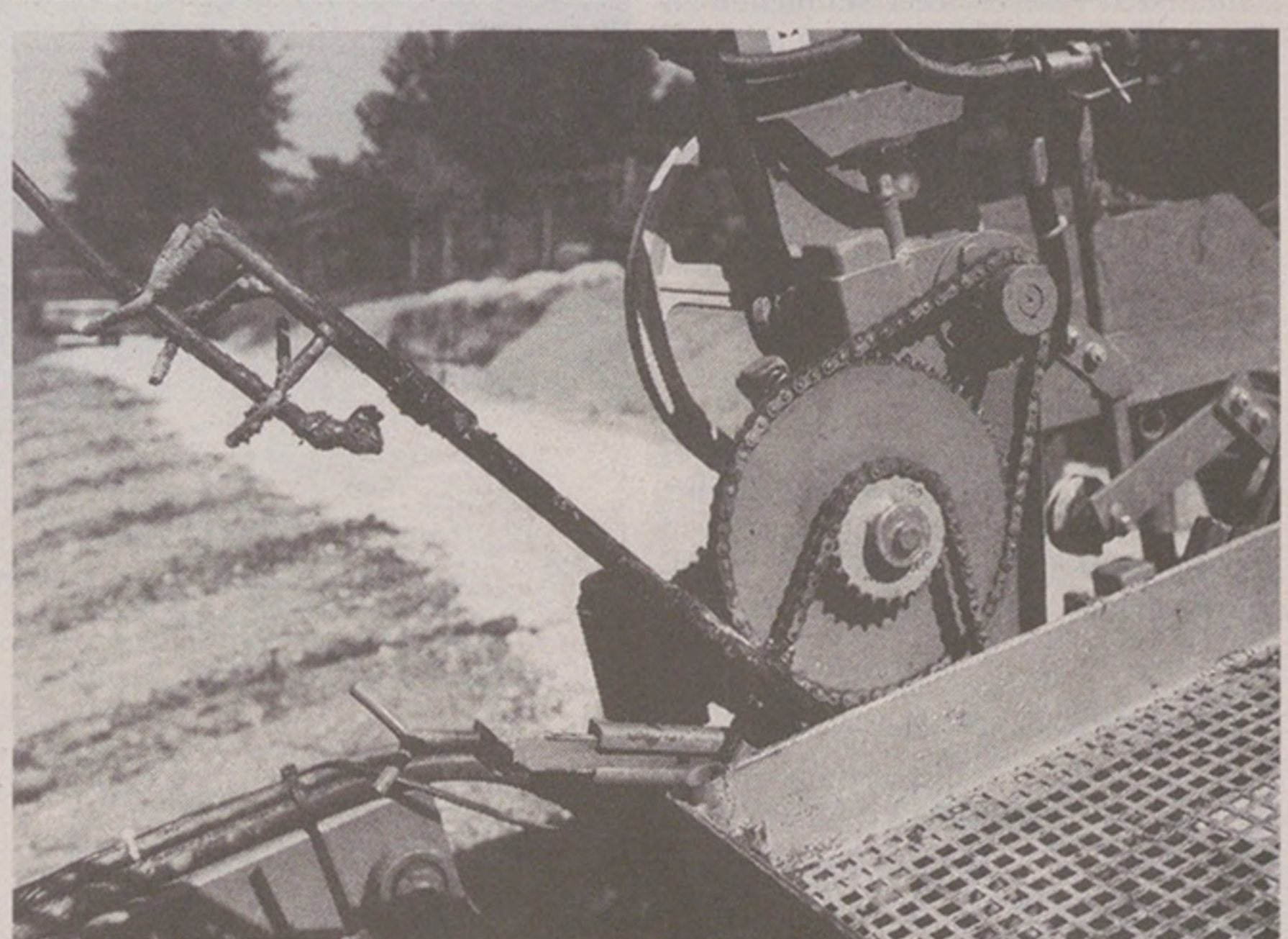
Einer der fünf Finger (links im Bild) führt die Rebe zur Erde, in die von zwei Pflugschwertern geöffnete Scholle. Anfang einer grossartigen Wertschöpfung der Natur zur Freude der Weinliebhaber.
