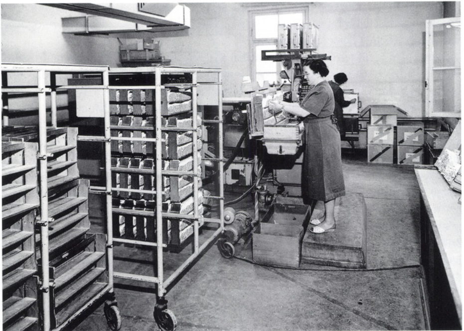
Die fertigen Zigaretten wurden in Rahmen angeliefert. Man erkennt solche rechts auf dem Sims, links im Transportwagen oder zuoberst auf der Verpackungsmaschine. Die abgefüllten Schachteln gelangten in die bereitstehenden Kartons (rechts hinten).
