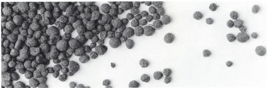
Der Klärschlamm der ARA Neugut wird hygienisiert und als Granulat aufbereitet an Landwirte abgegeben, die ihn als wertvolles Düngemittel einsetzen.
