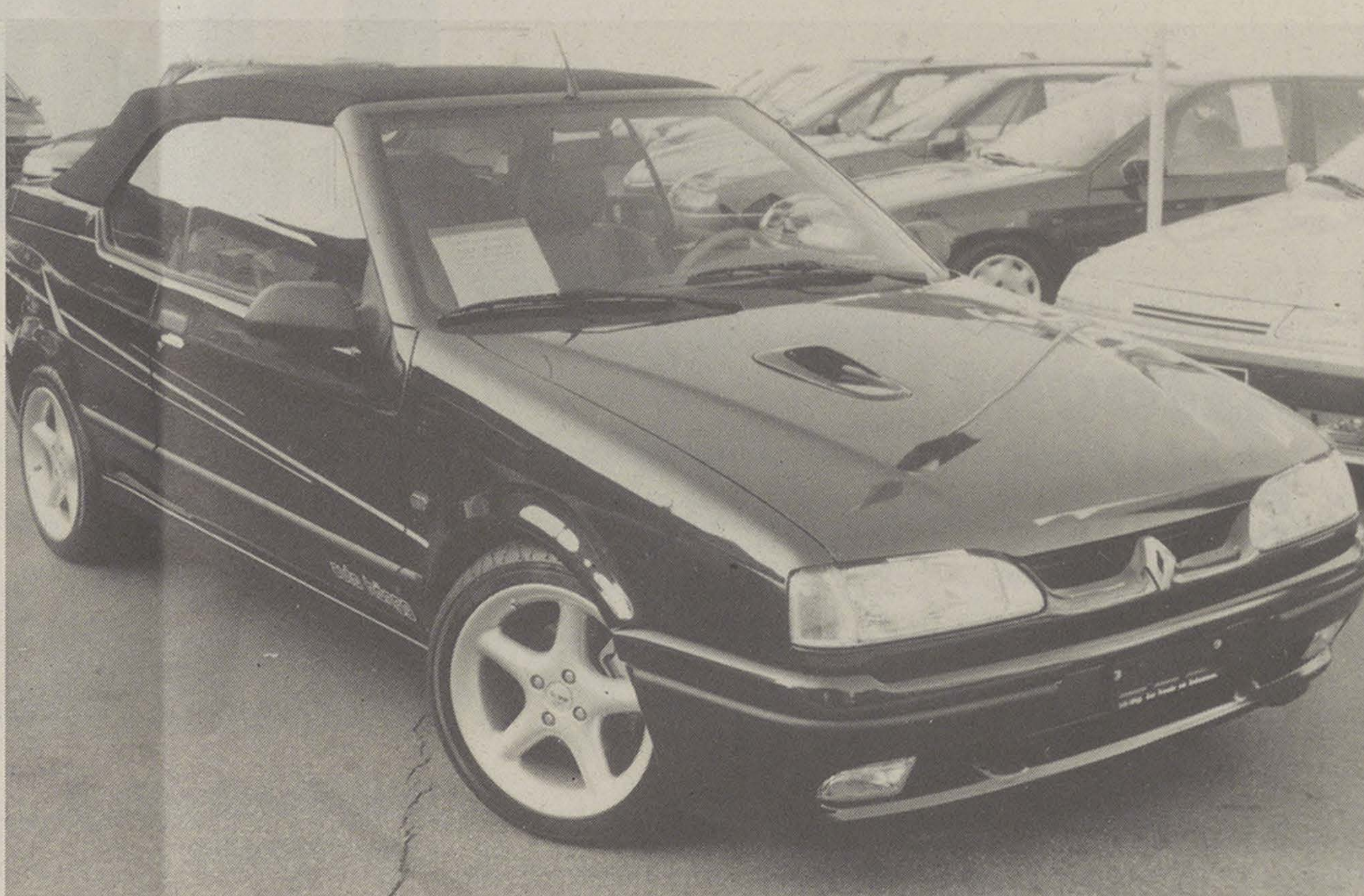
Renault 19 16V topmodisches, elegantes Cabriolet aus der Sonderserie Bolero. Ein paar technische Daten: Motor 1800 cm 3 , 145 PS, 10 PS mehr als Standardmodell, dank Motortuning durch Auto Höngg; ABS, Servolenkung, Innenausstattung in Leder, Spezialfelgen, Cabrioletverdeck mit einfacher Handhabung versenkbar.
