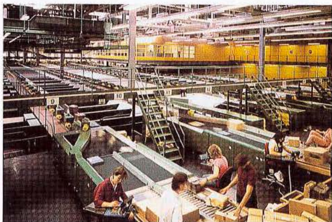
Auf kilometerlangen Förderbändern gelangen die Pakete zu den entsprechenden Versandbehältern.
