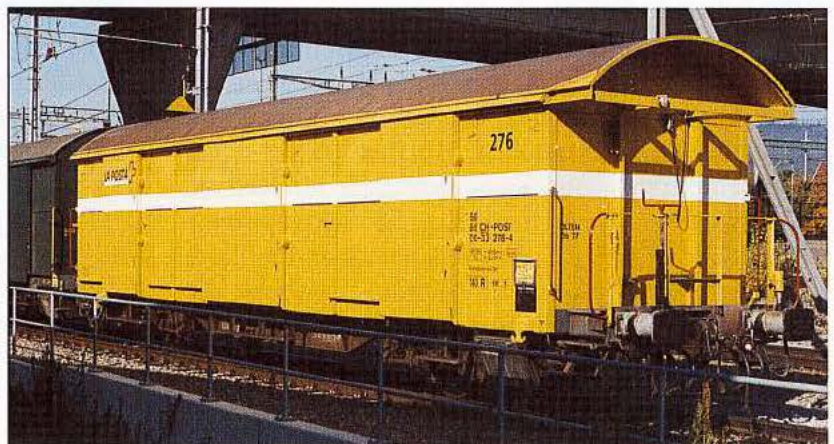
Bei diesen «neuen» Bahnpostwagen handelt es sich um ehemalige Gepäckwagen (Typ F) der SBB, die in den Werkstätten der Südost-Bahn umgebaut und umgespritzt wurden.
