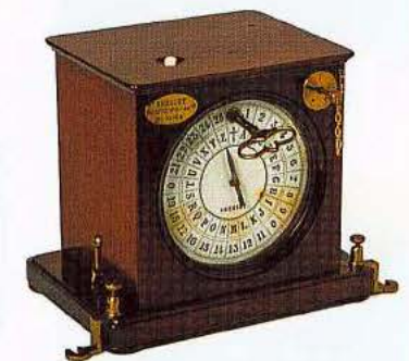
Mit dem Zeigertelegraphen von Werner Siemens (oben) übertrug man die Buchstaben und Ziffern noch als solche.
