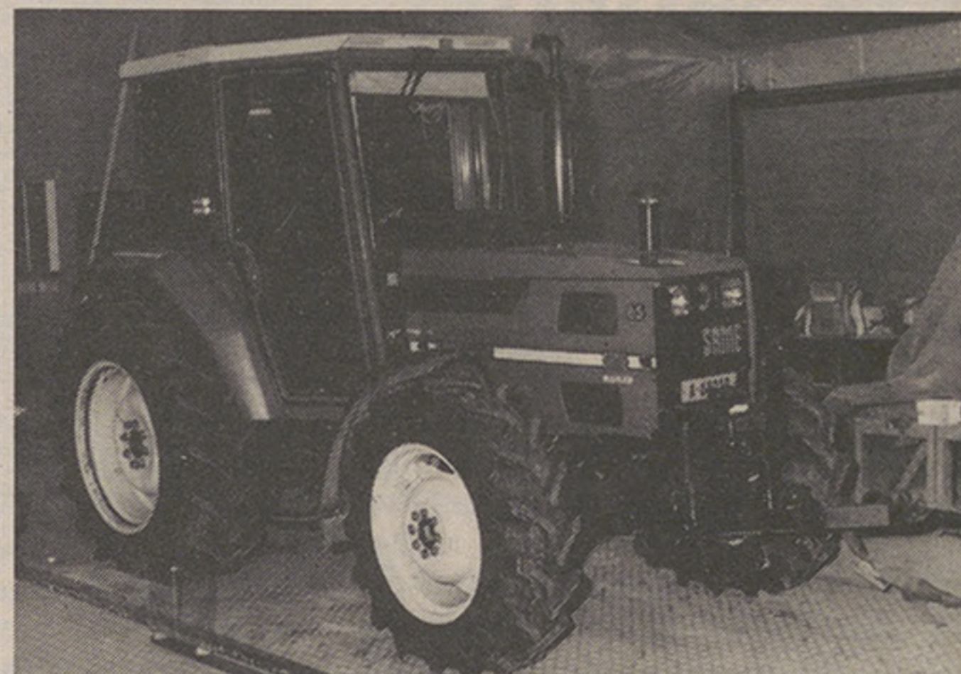
Dieser Traktor der Eidgenössischen Forschungsanstalt für Betriebswirtschaft und Landtechnik im thurgauischen Tänikon fährt mit geestertem Rapsöl.
