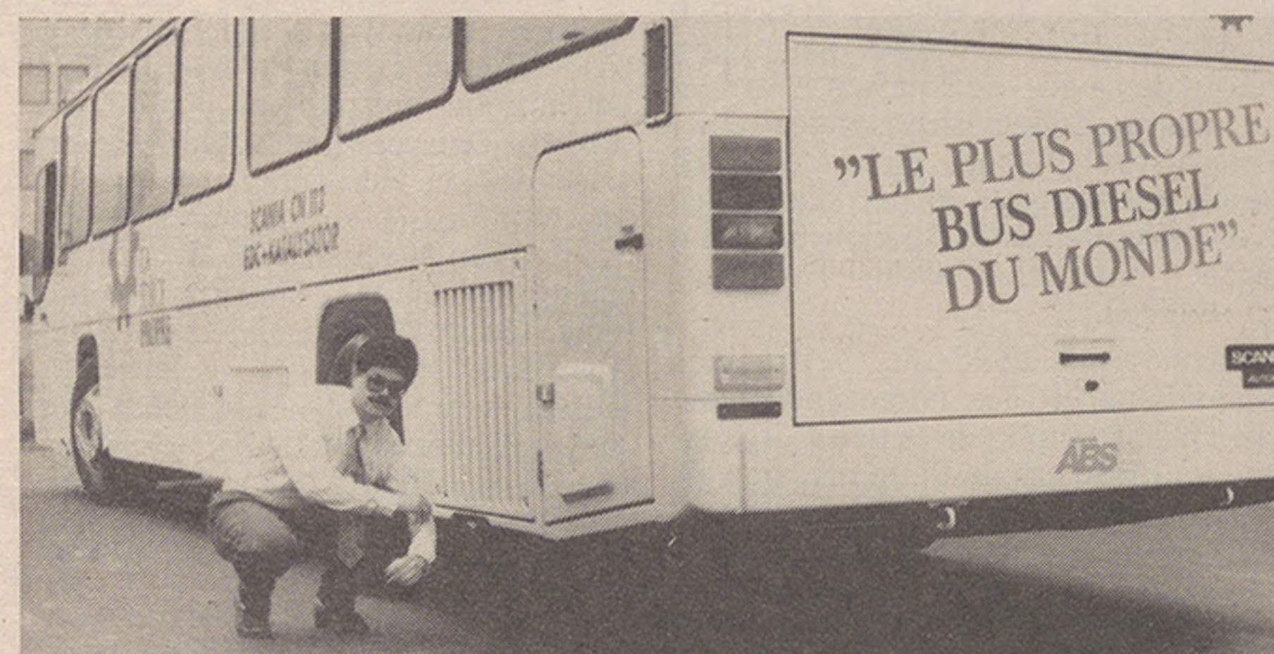
Dank schwefelfreiem Dieselöl, Katalysator und modernster Motortechnologie verblüfft dieser Scania-Bus die Fachwelt. Er wurde in Lausanne getestet.
