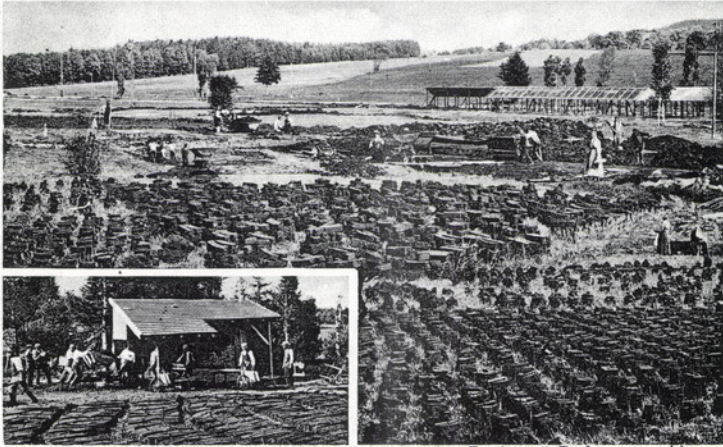
Torfgewinnung der Doldergesellschaft in Guldenen, bei Forch, mit Torfpressmaschine, welche täglich zirka 30,000 Stück Torf presst
