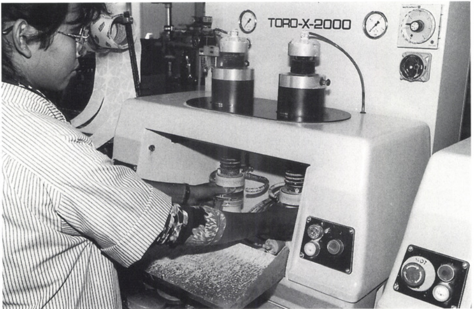
Schleif- und Poliermaschinen übernehmen das Verfeinern der Brillenglasoberfläche, um die hohe Lichtdurchlässigkeit zu erreichen.
