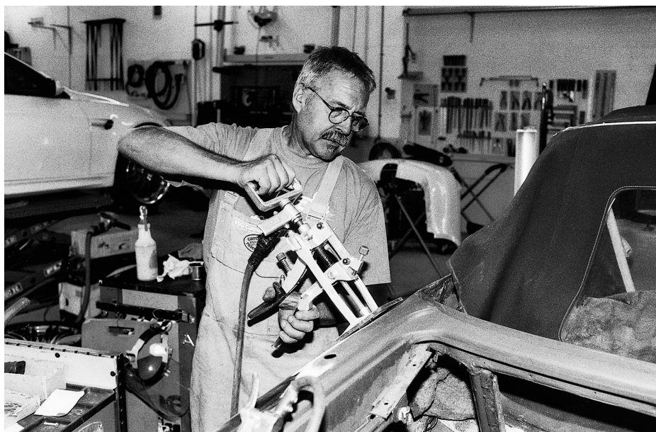
Bruno Maroggi, Carrosseriespenglermeister, drückt mittels des Spezialwerkzeugs «Miracle» eine Beule aus dem Kotflügel eines Cabriolets.
