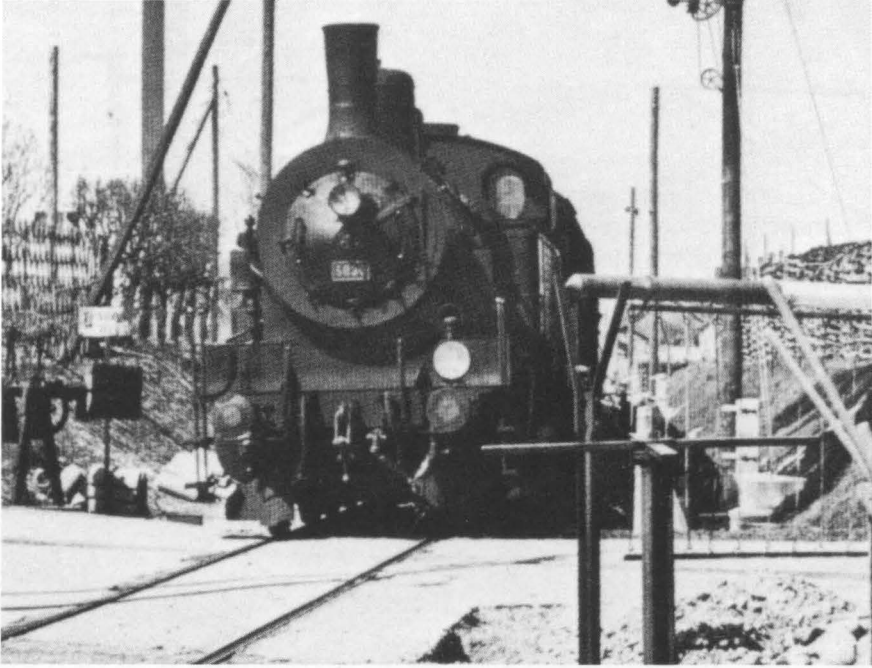
Tenderlok Eb 3/5 von vorne bei der Ausfahrt in Pfäffikon Richtung Kempten. Der Mast kündigt bereits die Elektrifizierung an (Bild Heimatspiegel, Wetzikon)
