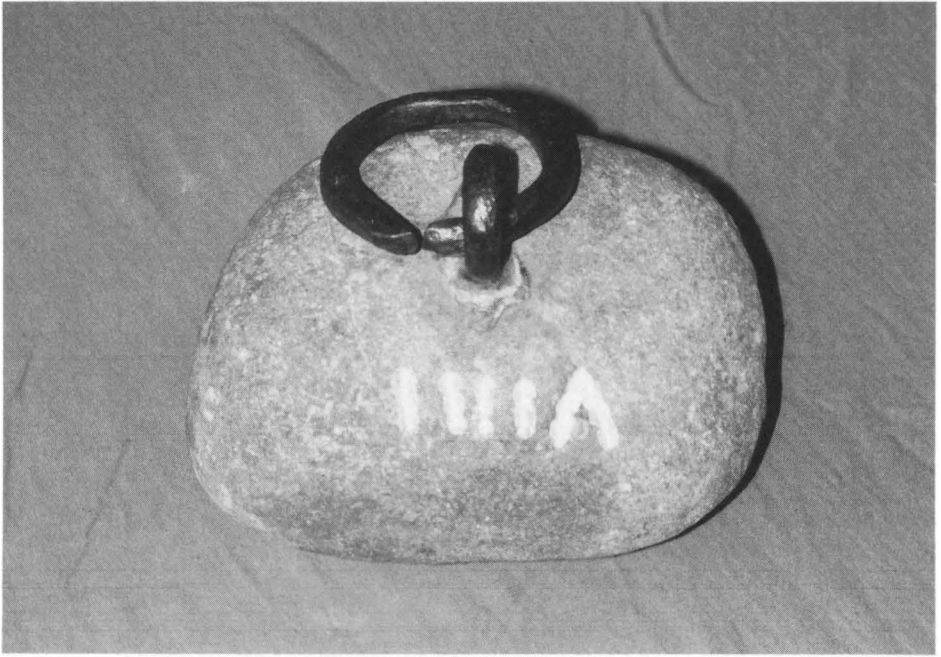
Steingewicht mit Eisenring, Schweiz: VIII (ungewöhnliche Schreibweise für 9) Pfund à 487 g, 19. Jahrhundert. (Fotos: Wolf Schellhammer)
