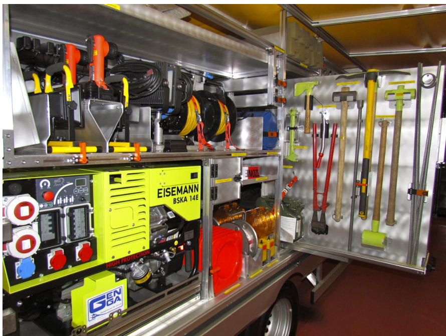
Generator, Kabelrollen, Werkzeuge: Das Innere des neuen Öl- und Wasserwehr-Fahrzeugs sieht wie ein kleiner Baumarkt auf Rädern aus. Bild: Toni Spitale
