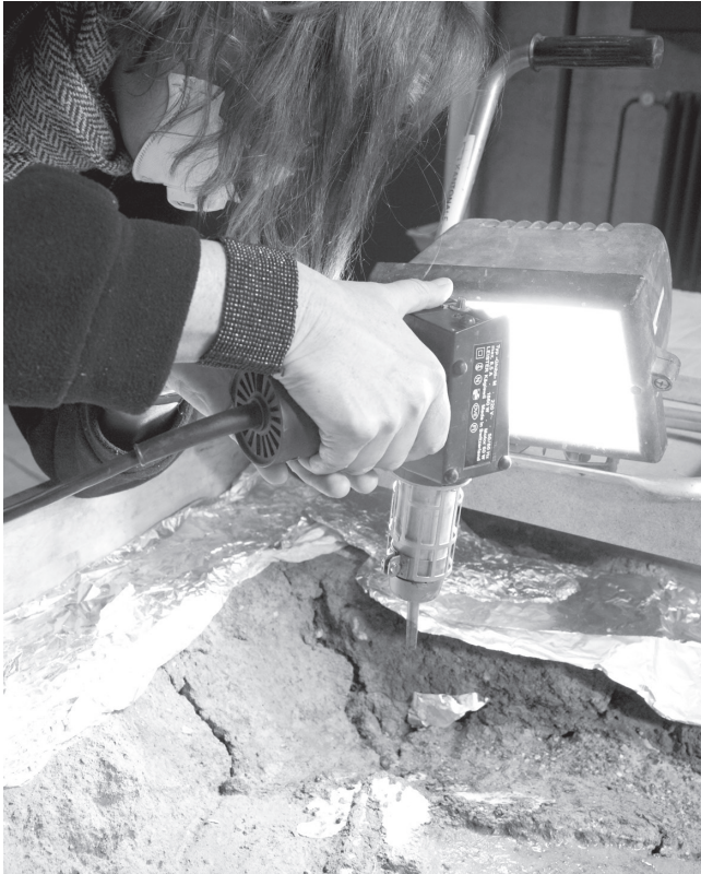
Abb. 30. Abdampfen des Cyclododekan mit einem Heissluftgebläse im Labor.
