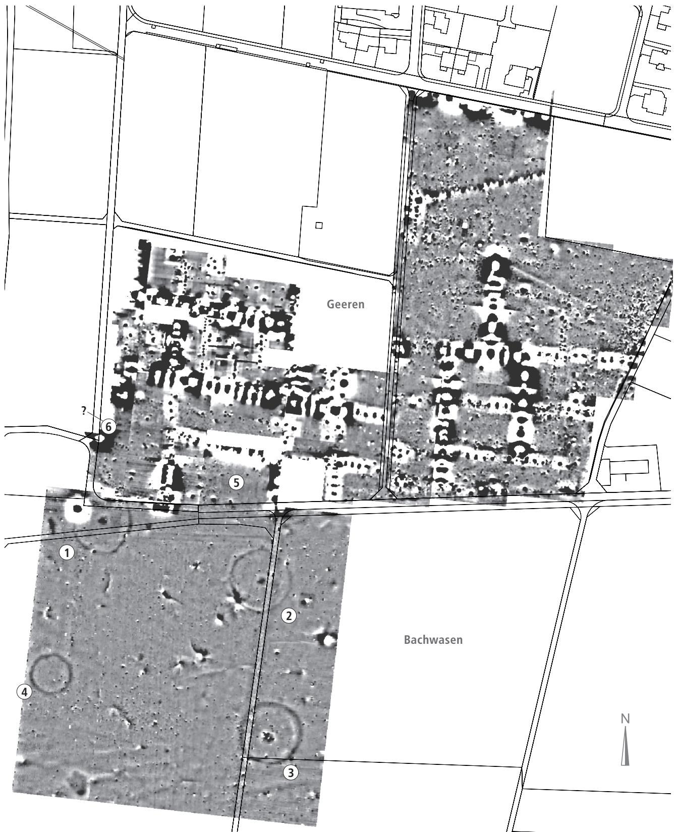
Abb. 18. Magnetogramm der eisenzeitlichen Nekropole von Oberstammheim-Geeren und Bachwasen. Nummer 1–5: Grabhügel. M: 1:2500. Pseudogradient in nT, Dynamik +/- 5 nT, Messungen im Raster 0,50 m x 0,15 m, interpoliert auf 0,25 m x 0,25 m in Graustufen. Messungen Christian Hübner, GGH Solutions in Geosciences GmbH, Freiburg im Br. (D).
