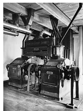
Mühleraum im 1. Obergeschoss mit zwei Walzenstühlen aus den 1930er Jahren von Maier & Cie., Gossau/SG. Die Mahlanlage wurde schon vor dem Umbau entfernt. Zustand 1984.
