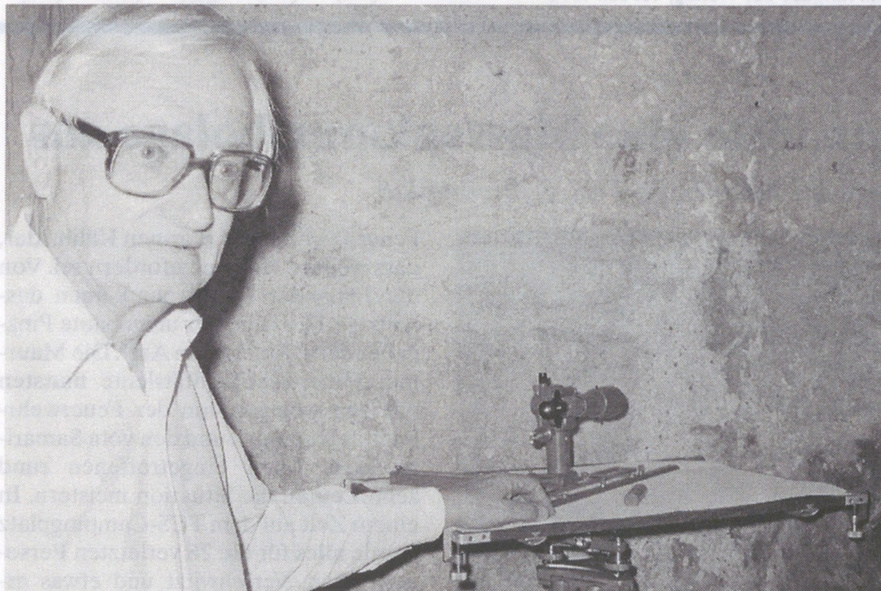
Ausstellungsmacher Werner Suter vor einem Messtisch mit einer Kippregel, die Bauingenieur Hans Hohl, Ebmatingen, dem Ortsmuseum als Anschauungsmaterial schenkte. (Foto go)
