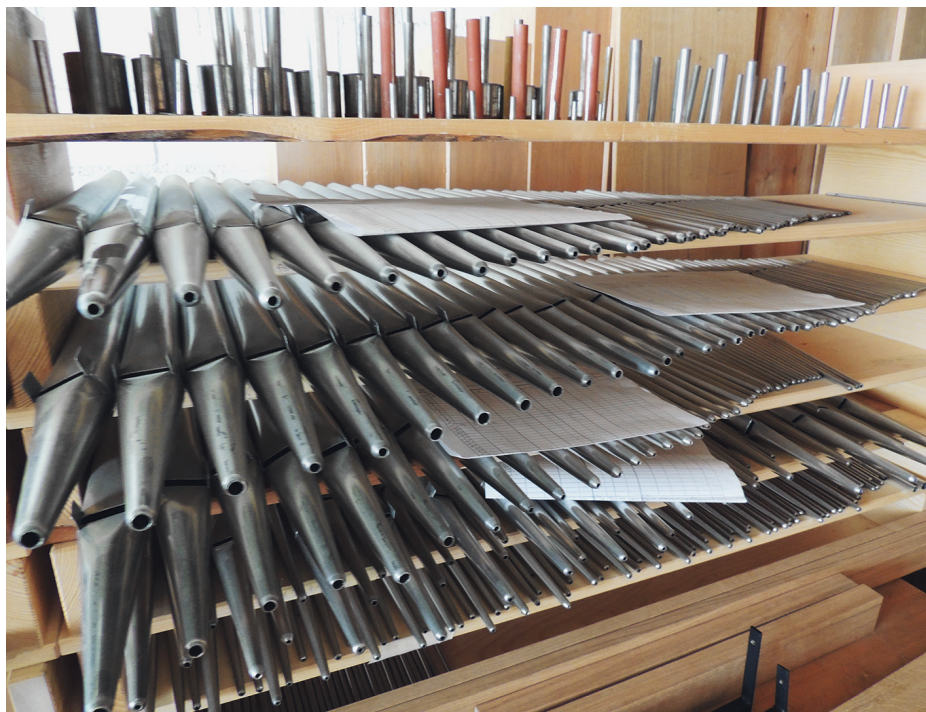
In der Werkstatt von Orgelbauer Bernhardt H. Edskes liegen die alten, überarbeiteten Pfeifen zur Lieferung bereit. Sie werden Teil der insgesamt 2300 Pfeifen der neuen Orgel sein.
