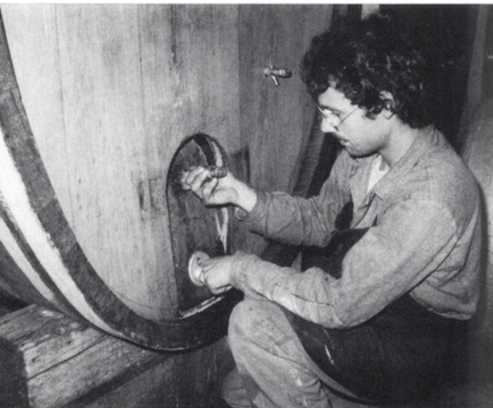
Xaver Steiner junior verschliesst ein Holzfass. Das Türli hat er vorher mit Talg eingestrichen.
