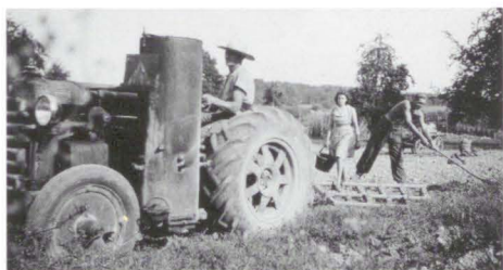
Kartoffelernte im zweiten Weltkrieg. Der angebaute Holzvergaser liefert die Energie für den Fordson Traktor von Ernst Bachofner, Nachbar der Familie Kägi.
