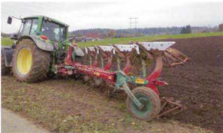
Heute ackert Jürg Kägi auf dem Neurütihof mit einem starken Traktor mit angebautem 4-Schar-Pflug.
