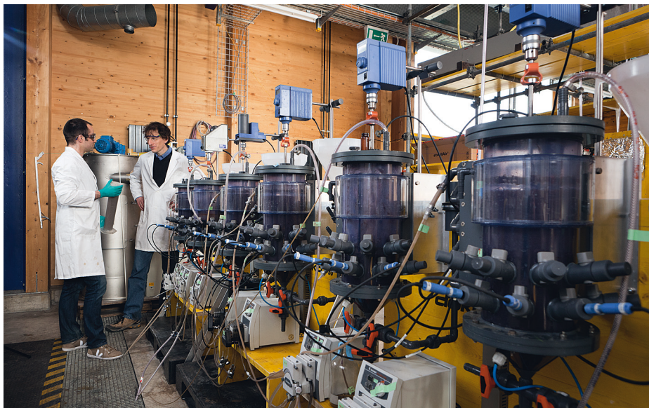
2011 laufen in der Versuchshalle in Dübendorf Tests zur Optimierung der Schlammbehandlung, für die Verbesserung der Stickstoffelimination und für eine Reduktion des Energieverbrauchs von Kläranlagen.
