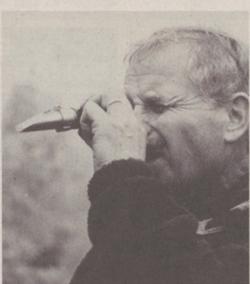
Emil Wegmann betrachtet kritisch eine Traubenbeere durch den Refraktometer. Mit diesem Instrument misst der Winzer den Öchslegehalt, der bis zu 88 Grad aufweist.
