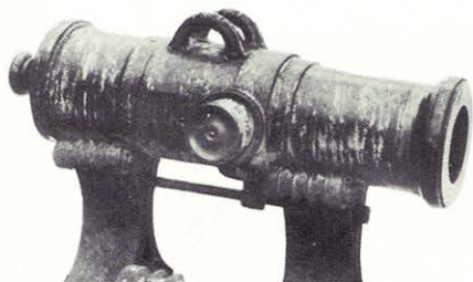
Rohr einer siebenpfündigen Haubitze der Oesterreicher, wie sie der Prinz von Lothringen mitführte. Rohrgewicht 280 Kilogramm, Kaliber 153 Millimeter, Kugelgewicht 7,5 kg. Wirkungsweite je nach Pulverladung und Aufsatzhöhe zwischen 600 und 1100 Metern, d.h. man musste sie etwa in die Mitte zwischen Dübendorf und Wangen hinstellen, um Dübendorf erreichen zu können.
