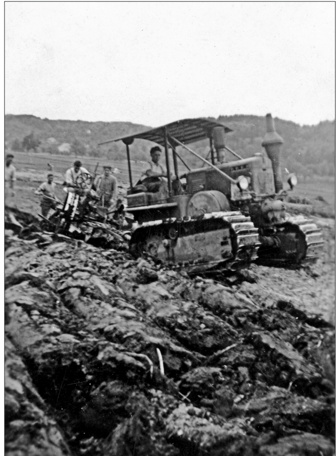
Abbildung 37 1942 wurden die entwässerten Riedwiesen erstmals gepflügt. Dabei setzte man einen Raupentraktor ein, mit geringem Bodendruck. Der an einer Kette nachgezogene Schwedenpflug musste ebenfalls von einem Maschinisten gesteuert werden.
