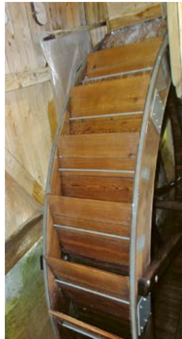
Das grosse Mühlrad wird vom Wasser angetrieben.
