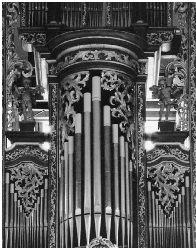
Abb. 101–104 Rheinau. Ehem. Klosterkirche. Hauptorgel. Versuche zur Ermittlung der absoluten Tonhöhe und des Temperierungssystems mittels verschiebbarer, auf die Pfeifen gesetzter Kartonverlängerungen, vor Beginn der Restaurierung. Fehlstellen bei den Schnitzereien wurden nach Möglichkeit berücksichtigt. Oben: Pedalausfelder links und rechts (Octave 8'). Unten links: Hauptwerk (Principal 8'). Unten rechts: Hauptturm rechts (Principal 16'E).
