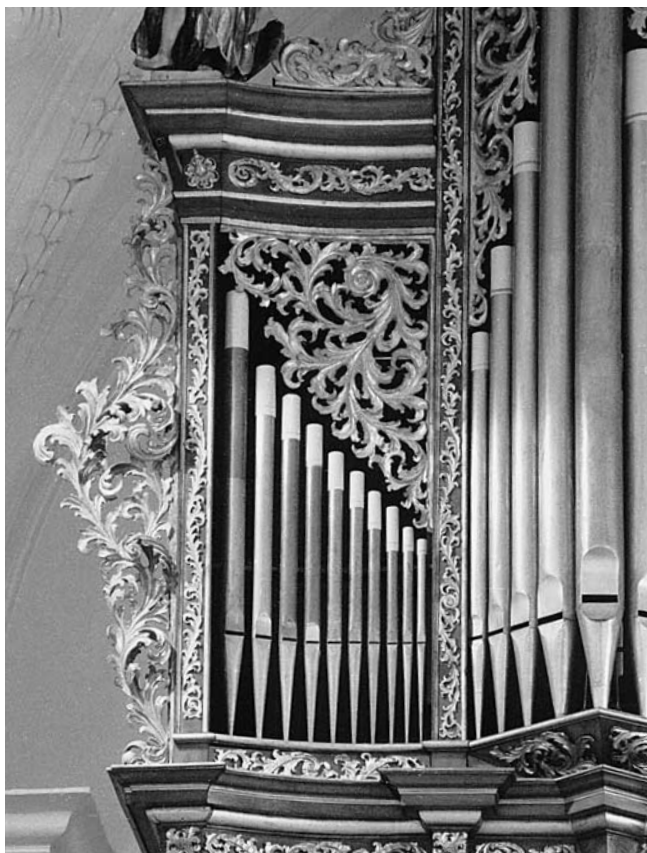
Abb. 101–104 Rheinau. Ehem. Klosterkirche. Hauptorgel. Versuche zur Ermittlung der absoluten Tonhöhe und des Temperierungssystems mittels verschiebbarer, auf die Pfeifen gesetzter Kartonverlängerungen, vor Beginn der Restaurierung. Fehlstellen bei den Schnitzereien wurden nach Möglichkeit berücksichtigt. Oben: Pedalausfelder links und rechts (Octave 8'). Unten links: Hauptwerk (Principal 8'). Unten rechts: Hauptturm rechts (Principal 16'E).
