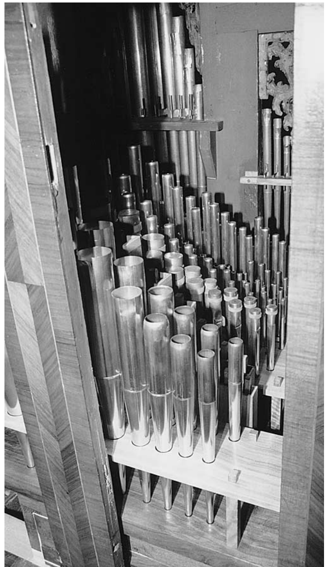
Abb. 35 Rheinau. Ehem. Klosterkirche. Hauptorgel. Blick in das restaurierte Pfeifenwerk des Rückpositivs. Im Vordergrund das restaurierte Register Nachthorn 4', im Hintergrund die von Haas erneuerten Prospektpfeifen.
