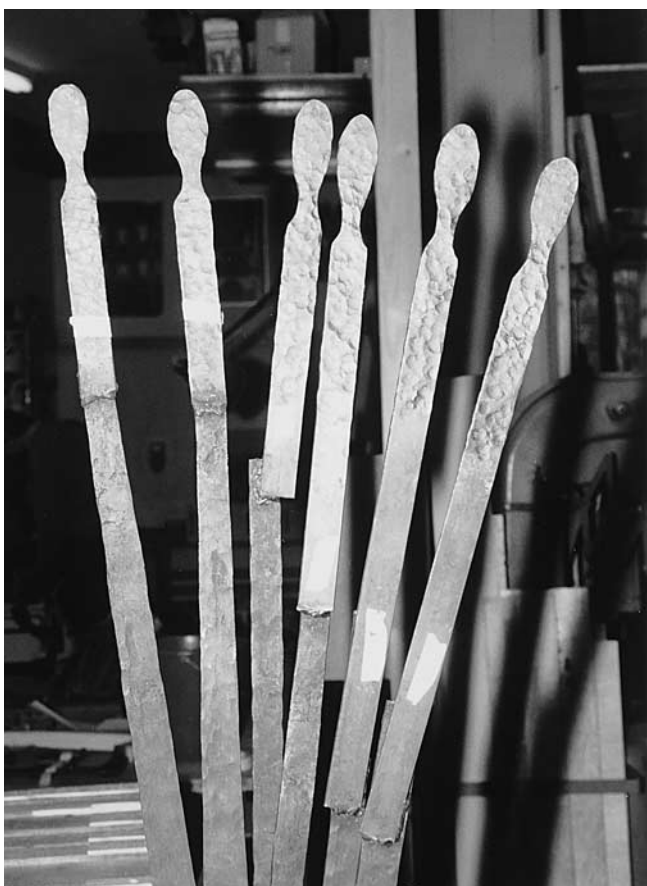
Abb. 139 Rheinau. Ehem. Klosterkirche. Chororgel. Die 1945 abgeänderten, gestreckten Registerzüge. Die angeschweissten, neuen Stücke enden in Handgriffen. Werkstattaufnahme der sechs Register der Diskantseite.
