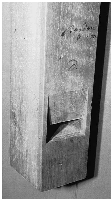
Abb. 30 Rheinau. Ehem. Klosterkirche. Hauptorgel. Eine Holzpfeife in der speziellen Machart Leus, mit einem durchlaufenden Deckbrett und fensterartig ausgestochenem Labium-Aufschnittbereich. Pfeife d 0 des Registers Coppel 8' im RP. Die Registeranschrift «Bordun 8' 2.M» sowie der Tonbuchstabe d stammen von Haas.
