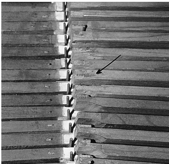
Abb. 60 Rheinau. Ehem. Klosterkirche. Hauptorgel. Die Wippen zur Betätigung der Oberwerktraktur ruhten vor der Restaurierung direkt auf den hinteren Enden der Tasten des III. Manuals, mit einer Belederung zur Lärmdämpfung. Da und dort sind noch Reste einer ursprünglichen Pergamentumfassung der Wippenenden zu sehen.
