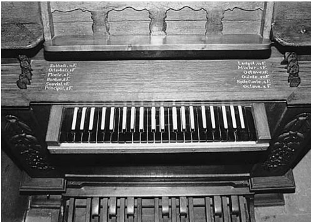
Abb. 131–133 Rheinau. Ehem. Klosterkirche. Chororgel. Spieltisch. Links: Zustand vor der Restaurierung mit vorgezogener, tiefergelegter Klaviatur (1841) und nach oben verlegter, oberständiger Registratur (1945). Rechts: Zustand nach der Restaurierung. Die rekonstruierte Klaviatur liegt wieder oben auf, die Registerzüge sind wieder in den vertikalen Staffeleien vorderständig untergebracht. Unten: Die originale Pedalklaviatur von 1726 oder 1746 vor der Restaurierung, etwas aus der Position nach links geschoben; gut erkennbar sind der später untergesetzte Rahmen aus Tannenholz und die Einsenkung in den Fußboden.
