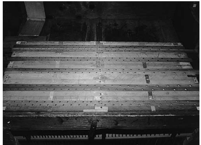
Abb. 44–45 Rheinau. Ehem. Klosterkirche. Hauptorgel. Oben: Die von Leu 1715 nachgelieferte Lade für das Oberwerk ist chromatisch angelegt; im Bild rechts der Bass, links der Diskant; die Pfeifenstöcke sind abgebaut, man erkennt die sechs gelochten Schleifen. Unten: Die originalen Pedalladen von Leu haben doppelte Ventilkästen, welche mit einer Wellenmechanik verbunden sind. Die meisten der Wellenlager aus Nussbaumholz sind alt.
