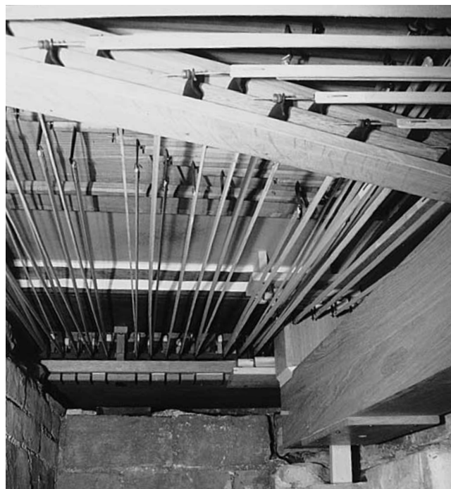
Abb. 137 Rheinau. Ehem. Klosterkirche. Chororgel. Rekonstruierte Pedalmechanik unter der Manuallade; im Hintergrund der Abgang von der Pedalklaviatur, im Vordergrund die 90°-Umlenkung Richtung Pedallade.
