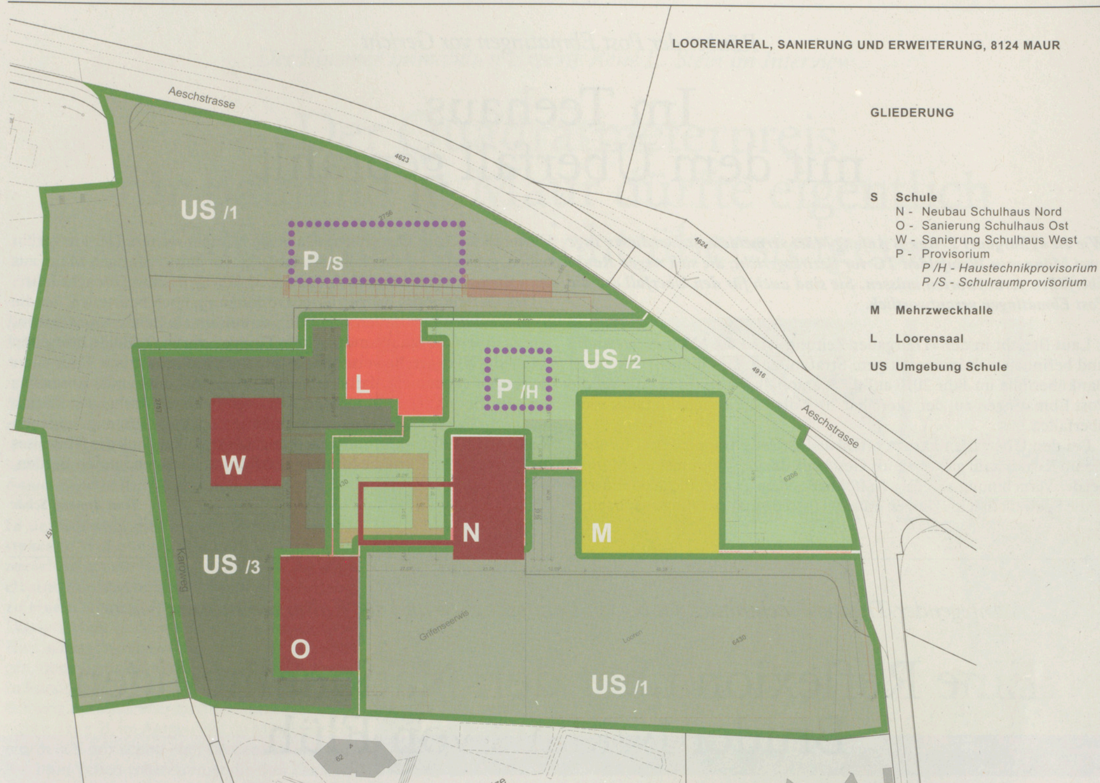
Übersicht über die geplanten Arbeiten: Neu gebaut wird nur der Trakt Nord, saniert werden die Trakte Ost und West sowie der Loorensaal und die Dreifachhalle (Mehrzweckhalle). Bild: zVg
