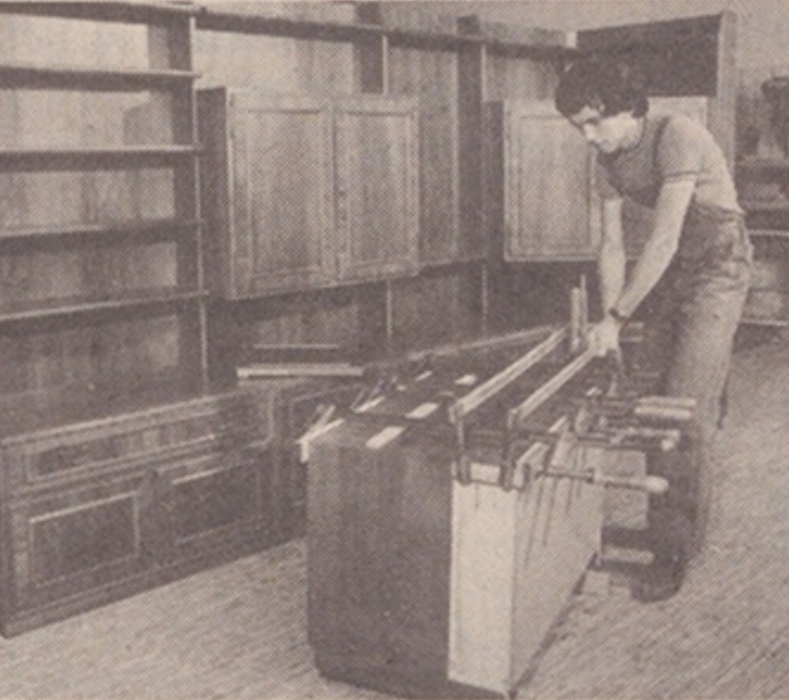
Eine bereits existierende Wohnwand wird im Schreinereibetrieb den neuen räumlichen Massen angepasst. Eine Arbeit, die fachwerkliches Können fordert. Der nachträgliche An- oder Umbau wird unsichtbar bleiben.
