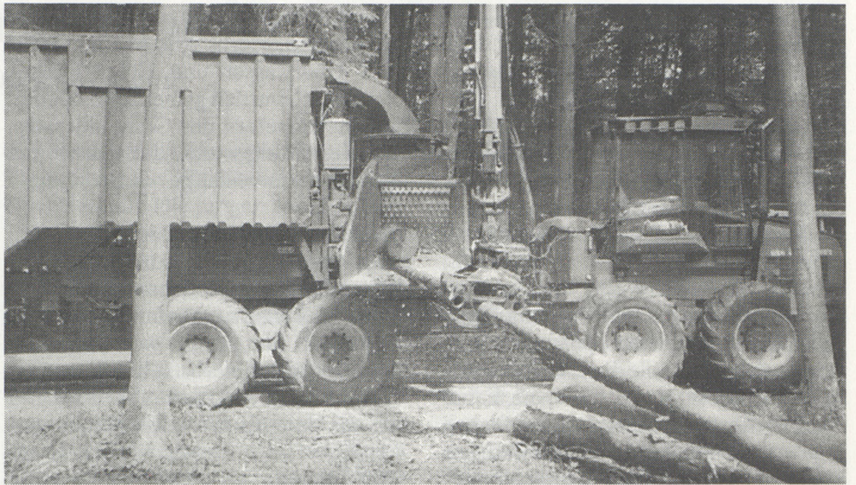
Ein Greifarm hebt die Stämme, schiebt sie in die mobile Schnitzelanlage, wo eine grosse Raspel das Holz innert weniger Minuten zu Schnitzelholz verarbeitet. Dieses kann mit einem bis zu 45prozentigen Wassergehalt verheizt werden, muss also nicht trocken sein. (Fotos el)
